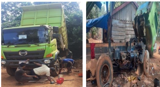
Gambar 4. Pergantian Pelor Roda dan Pengecekan Mesin pada Dump Truck
