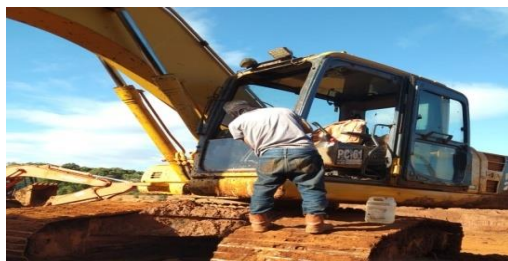
Gambar 5. Pengecekan Mesin pada Excavator
